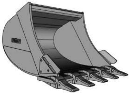
Применяется для разработки грунтов I-IV категорий плотностью до 1600 кг/м<sup>3</sup>. Подходит для проведения стандартных земляных работ на мягких и легких грунтах с малой абразивностью, разгрузки сыпучих материалов (песок, суглинок, растительный грунт, щебень).
