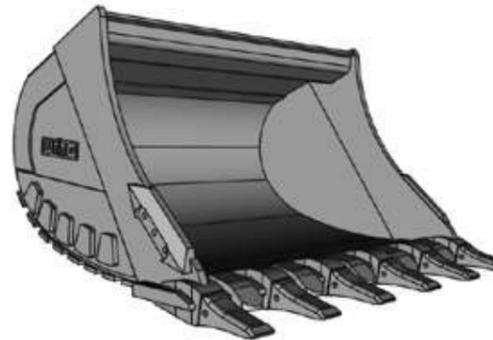
Предназначен для разработки грунтов плотностью до 2000 кг/м<sup>3</sup>.
